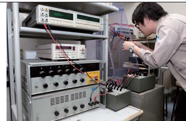
▲精密電気抵抗測定装置
